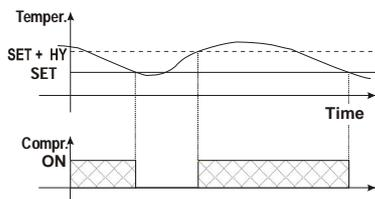
Der Verdichter wird oberhalb des Sollwert SET plus Schalthysterese Hy eingeschaltet und exakt am Sollwert SET wieder abgeschaltet. Siehe Abbildung.
